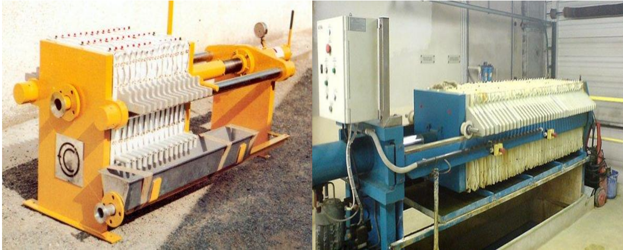
Figure V.3 : Filtration par filtre presse.
