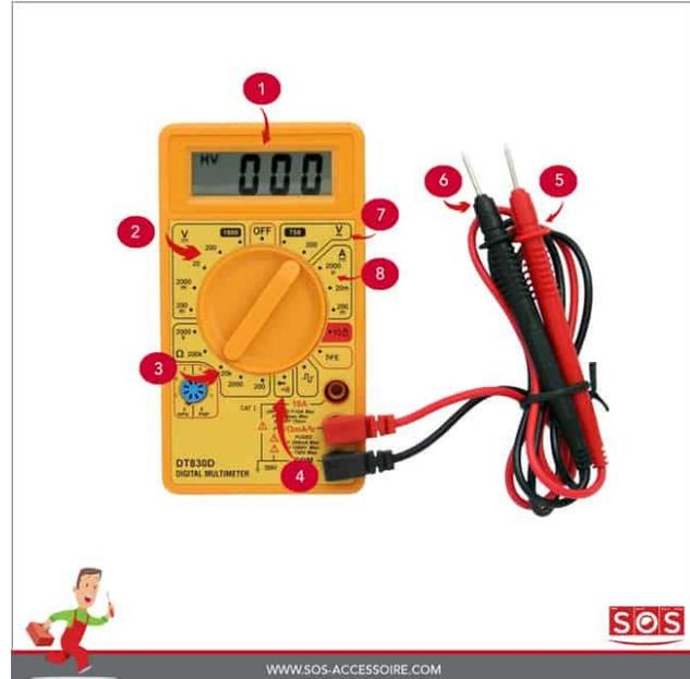
1. La borne commune "COM" ou borne moins (-) est celle sur laquelle on connecte toujours le fil noir quelles que soient les mesures que l'on souhaite réaliser.
