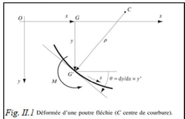
Fig. II.1 Déformée d'une poutre fléchie (C centre de courbure).
