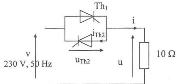
Figure 2 : Gradateur monophasé sur charge résistive
