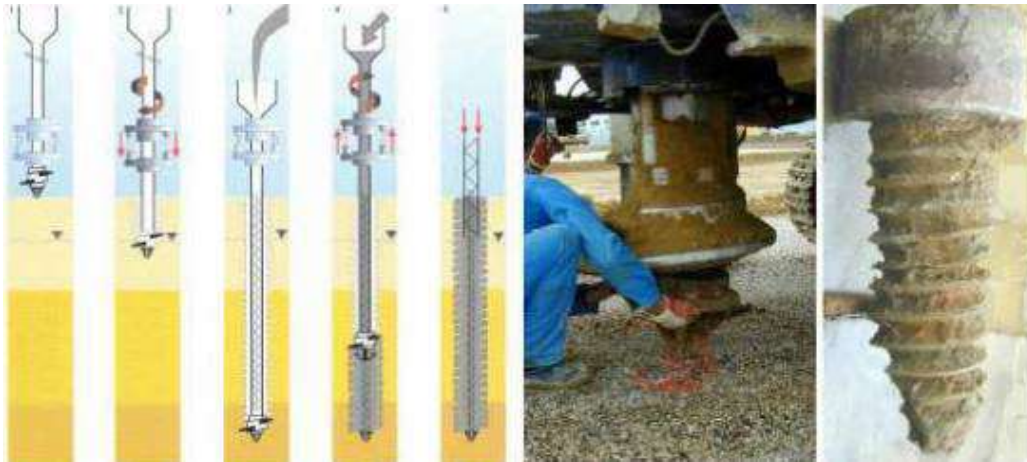
Fig. 3. 4 Pieu vissé de type Oméga à deux pas de vis ou un seul
