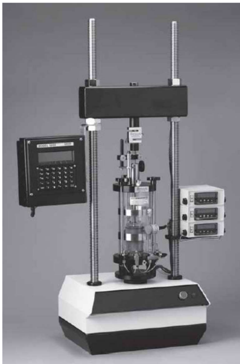
Fig. I. 9 Principe d'essai triaxial (la cellule triaxial).
