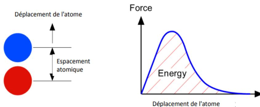
La discussion ci-dessus a présenté le concept de l'énergie de la liaison atomique. Afin de rompre une liaison, une quantité de travail égale à l'énergie de liaison doit être effectuée sur le système. La figure suivante étend cela au cas d'une fissure se développant dans un solide.
