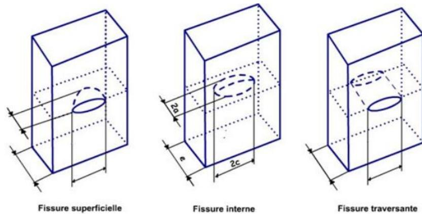
**Figure 1.** Les différents types de fissures
