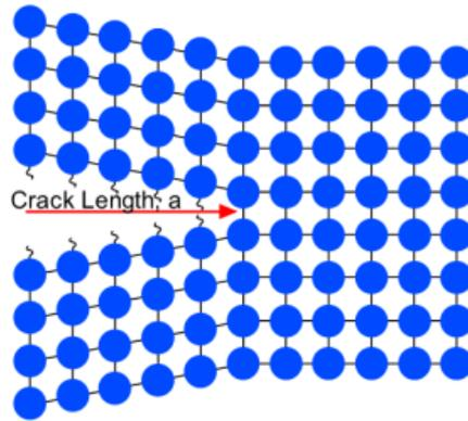
La figure montre une fissure qui a grandi à la longueur,  $a$ , et dans le processus, a rompu plusieurs liaisons atomiques le long du chemin, chacun nécessitant une certaine quantité de travail pour surmonter l'énergie de la liaison atomique. L'énergie totale est exprimée en :
