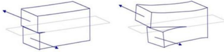
**Figure 3.** Propagation en mode III
