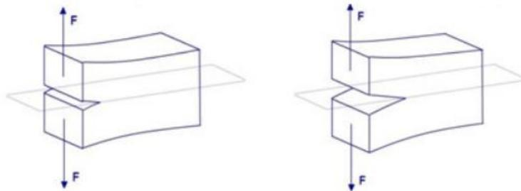
**Figure 2.** Propagation en mode I
