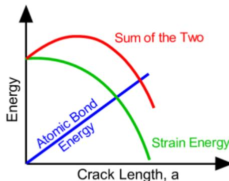
L'idée clé est de reconnaître que pour de courtes longueurs de fissure (à gauche de la valeur maximale sur le graphique), l'énergie totale de l'objet augmente avec l'augmentation de la longueur de la fissure. Par conséquent, de l'énergie supplémentaire doit être introduite dans le matériau afin de provoquer la croissance de la fissure. Il est stable.
