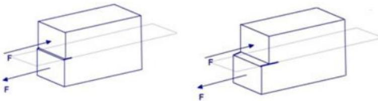
**Figure 2.** Propagation en mode II
