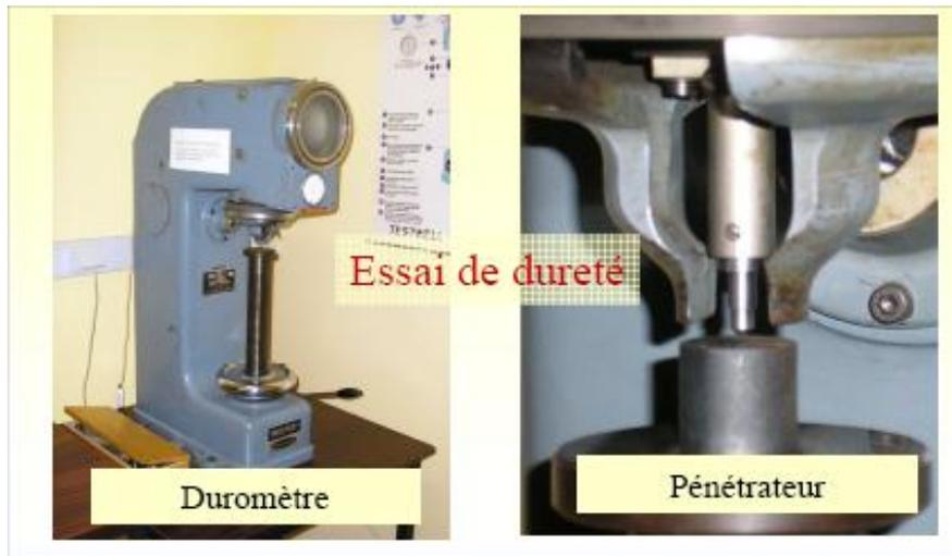
Figure II.22. : Photo d'un duromètre et son pénétrateur
