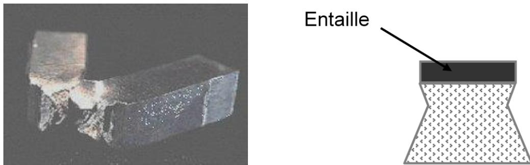
Figure II.36. : Rupture ductile. Pliage avant rupture
