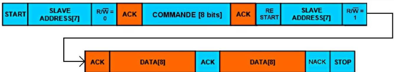
**On remarque que pour que le maître envoie une commande il faut mettre le bit R/W à 0 et pour que le maître lise les données envoyées par un esclave il faut mettre le bit R/W à 1** et en signal électrique
