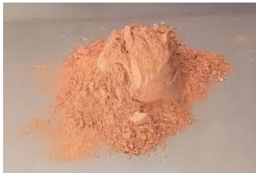
Figure 1.3 : Métakaolin flash issu du site de Fumel. Sa coloration rosée est due à une teneur faible en oxyde de fer (2,5 % environ).
