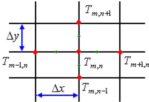
المطلوب درجة حرارة النقطة  $T_{m,n}$  في الوقت الذي درجة حرارة النقاط التي تحيطها معلومة .
