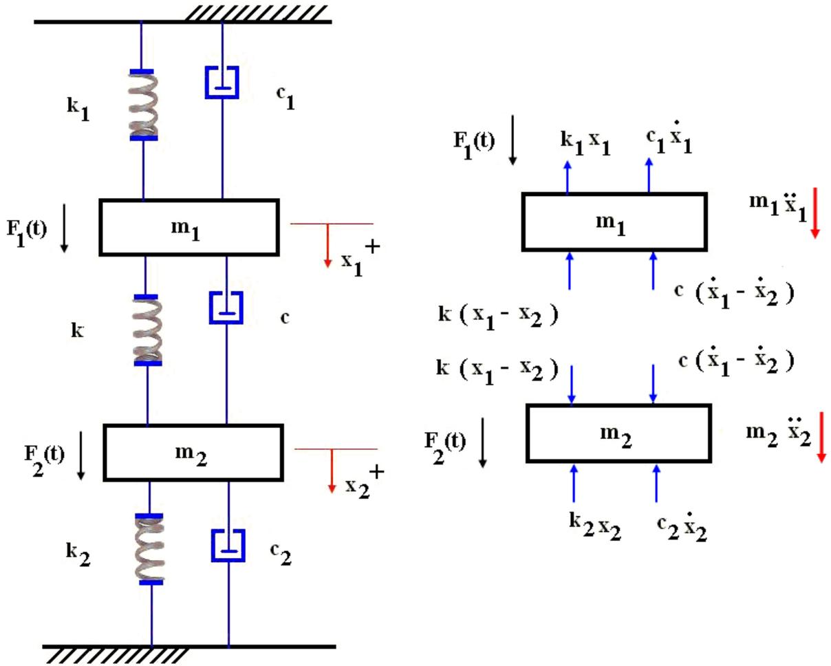
$$\begin{cases} m_1 \ddot{x}_1 + (c + c_1) \dot{x}_1 + (k + k_1) x_1 - c \dot{x}_2 - k x_2 = F_1(t) \\ m_2 \ddot{x}_2 + (c + c_2) \dot{x}_2 + (k + k_2) x_2 - c \dot{x}_1 - k x_1 = F_2(t) \end{cases}$$
