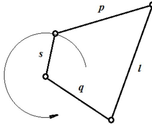
La loi de Grashoff pour un mécanisme à quatre barres stipule si la somme des longueurs des barres la plus longue et la plus courte est inférieure ou égale à la somme des longueurs des autres barres alors la plus courte peut effectuer un tour complet par rapport à la barre voisine.
