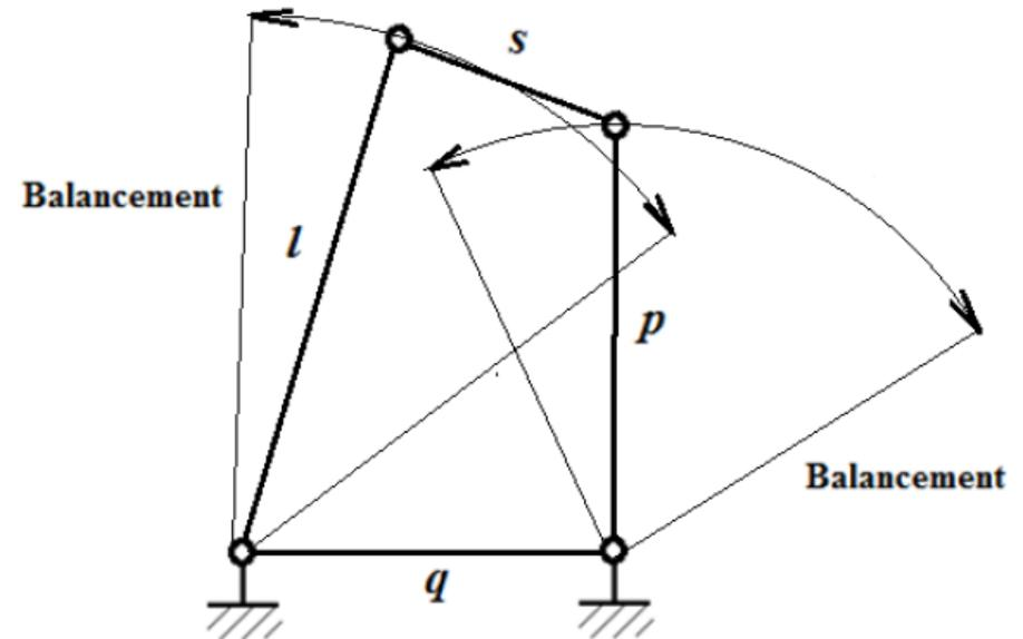
**4.3. Loi de Grashoff pour les mécanismes à 4 barres****4.3.4. La barre courte a liaison avec le bâti et formant un parallélogramme avec les autres barres**
