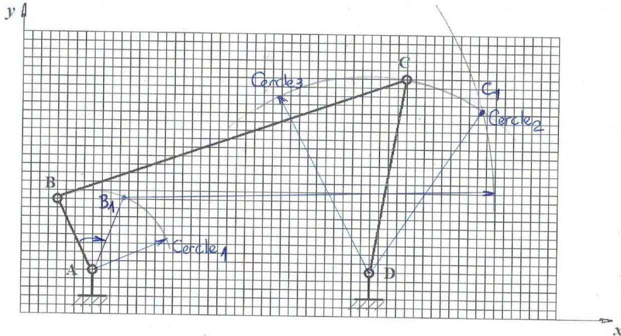
En analysant le mécanisme on trouve que la barre AB tourne autour de A (Cercle1), la barre BC tourne par rapport à la barre AB autour de B et la barre DC tourne autour de D (Cercle3).
