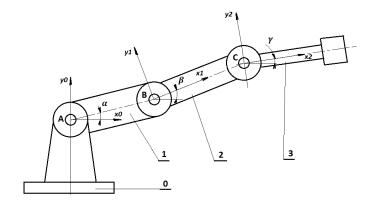
Si on omet les 3 dernières équations on aura 15 inconnues (les réactions aux niveaux des liaisons A, B et C) et 15 équations donc h = 0 et le système est isostatique
