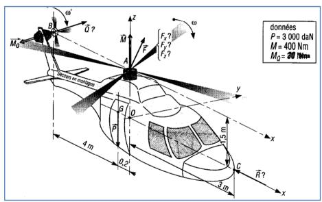
$\vec{R}$  est la résistance de l'air sur l'ensemble de l'appareil et  $\vec{P}$  le poids total.
