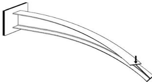
Figure 1. Déversement d'une poutre en acier
