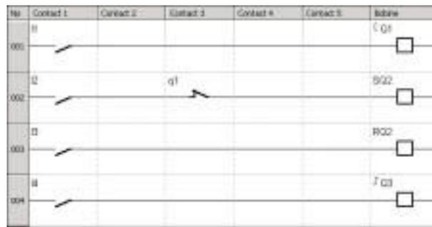
Dans cet exemple, les 3 type de bobines sont utilisées : Contacteur **Q1**, Set/Reset **Q2** et Télérupteur **Q3**. **Q1** recopie l'état de l'entrée **I1**. **Q2**, lui, ne pourra être activé que **I2** passe à l'état haut pendant que la bobine **Q1** est au repos (**q1** fonction inverse de **Q1**) . Un appui sur **I3** permettra de désactiver **Q2**. Enfin, **I4** commande la bobine télérupteur **Q3**.
