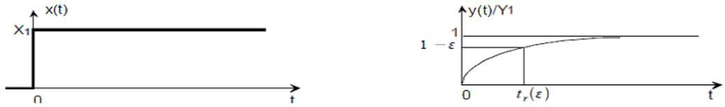
Signal d'entrée  $x(t)$  (a) Temps de réponse d'un dispositif du 1<sup>er</sup> ordre
