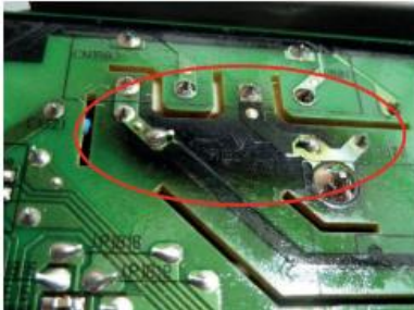
(a): Traces de surchauffe sur le recto et le verso d'un circuit
