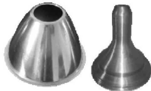
Fig.04. Exemples de pièces repoussées
