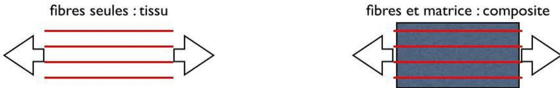
La matrice empêche (dans une certaine mesure) les fibres de flamber en compression et en cisaillement
