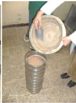
Versement du sol
