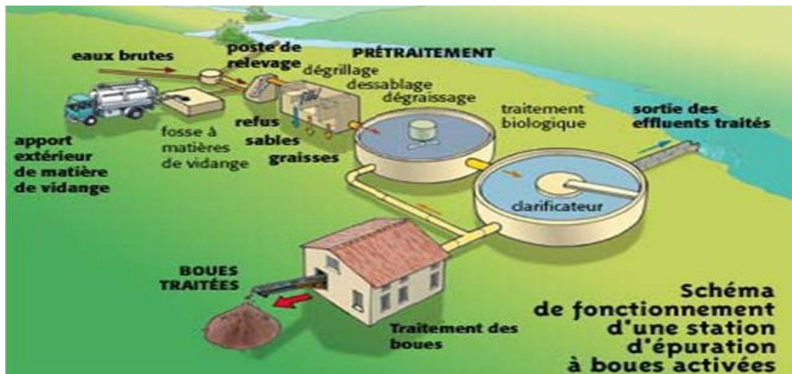
Figure 2.5 : Station d'épuration de l'eau.
