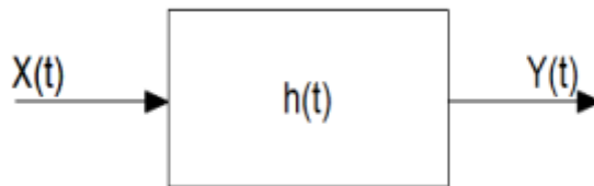
Figure 3.6 : Filtrage d'un signal aléatoire X(t) par un filtre de réponse impulsionnelle h(t) .
